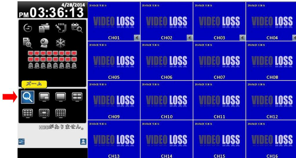
デジタルズームモードでは、マウスを使用して赤長方形を動かすとズームエリアが移動します。
