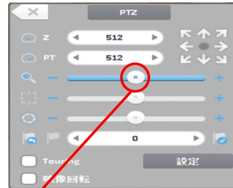
虫めがねマークの○を右にスライドすると望遠側、左にスライドするとワイド側にレンズが稼働します。
